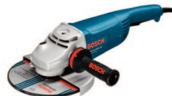
Ref. A016889 AMOLADORA GWS 22-230 J BOSCH 2.200 W. 230 mm. 6.500 rpm. Arranque suave. Protección contra re arranque. Interruptor tri-control. Empuñadura auxiliar. Caperuza protectora. Llave de 2 agujeros. Tuerca de apriete. 5,2 kg. 131,80€
